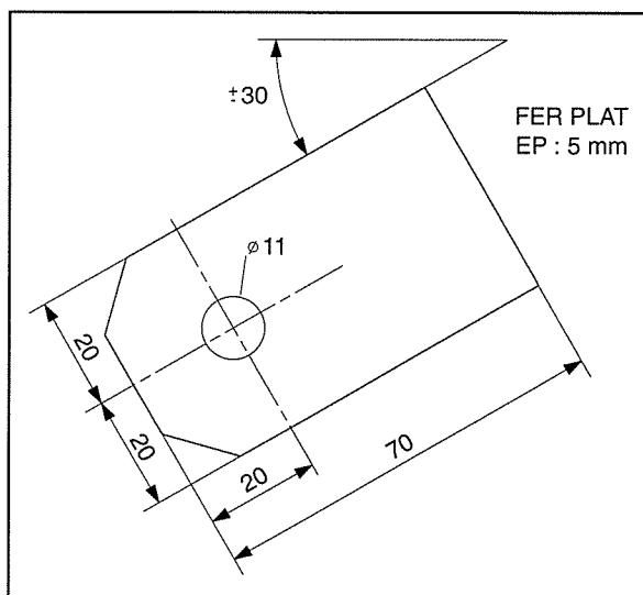
Fabriquer les supports de fixation à partir de deux morceaux de fer plat de 40 mm de largeur et de 5 mm d'épaisseur, comme il est indiqué ci-contre.
